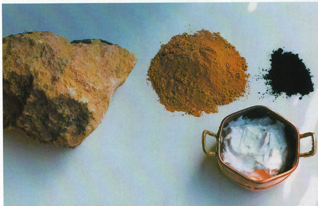
I componenti per ottenere il Giallo Torino: la calce gialla di Casale e la calce bianca con le terre coloranti naturali.
